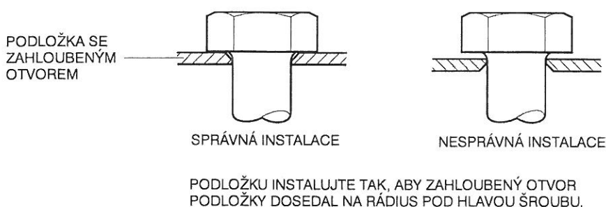
Obr. 20–1 Instalace podložky
